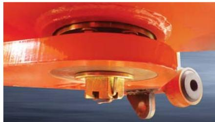
Метод шарнирного соединения передней и задней рам был изменен путем замены конических роликовых подшипников на подшипники качения, что эффективно устранило такие общие проблемы, как неплотности и поломки.
