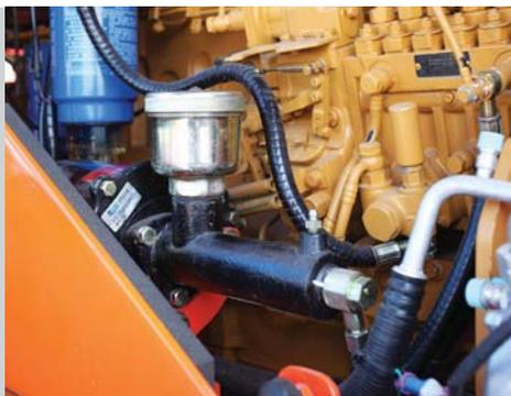
Подпиточный насос создает более высокую степень форсированной тяги, улучшает эффективность торможения и облегчает ежедневное техническое обслуживание, благодаря тому, что устанавливается на кузове.
