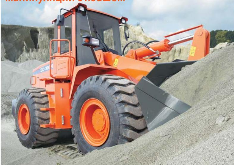
Увеличение угла наклона  $\alpha_3$  в положении переноса позволяет погрузчику двигаться по ухабистым дорогам, не теряя материала; увеличение угла опрокидывания  $\alpha_2$  позволяет быстрее и полностью вываливать материалы.
