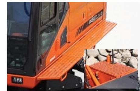
**Мостки (платформа) в стандартной комплектации DX480LCA-HD и DX520LCA-HD**
