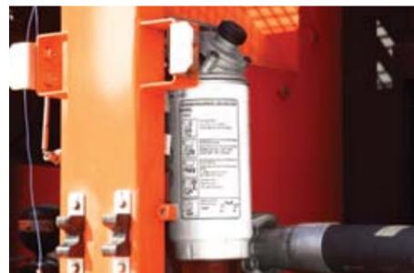
**Фильтр предварительной очистки топлива с отделителем воды**
