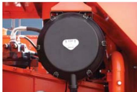
**Воздушный фильтр и пылеотделитель с предварительной фильтрацией**
